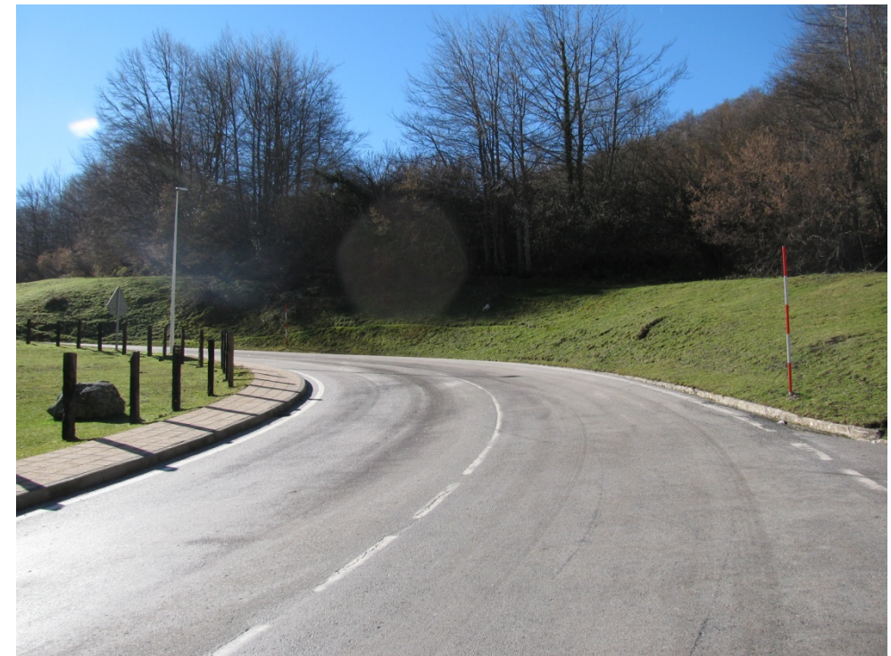
FOTO 6: En la parte derecha de la fotografía se construirán aceras y a la izquierda de la aceras existentes realizaremos la duplicación de la calzada existente, con la misma anchura de la actual. Será necesario disponer de elementos de drenaje adecuados a la nueva situación.
