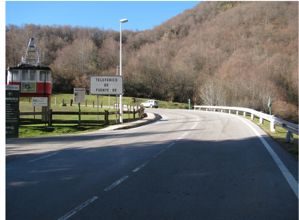
FOTO 2: En la parte derecha de la fotografía, junto a la actual bionda, se construirán unas aceras para facilitar el embarque y desembarque de los viajeros. A partir de cartel con la inscripción "TELEFERICO DE FUENTE DÉ", está previsto duplicar la calzada.
