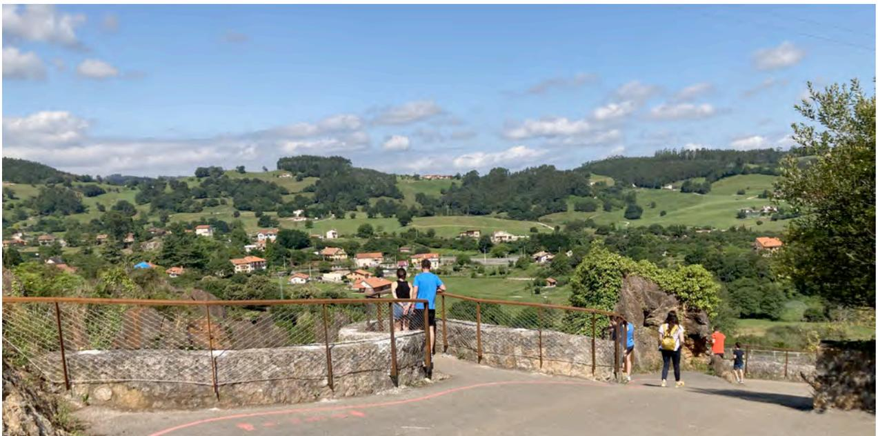
Valla de mirador con pasamanos, de 1,2m de altura, anclada lateralmente al muro de piedra para impedir el acceso a su coronación.
