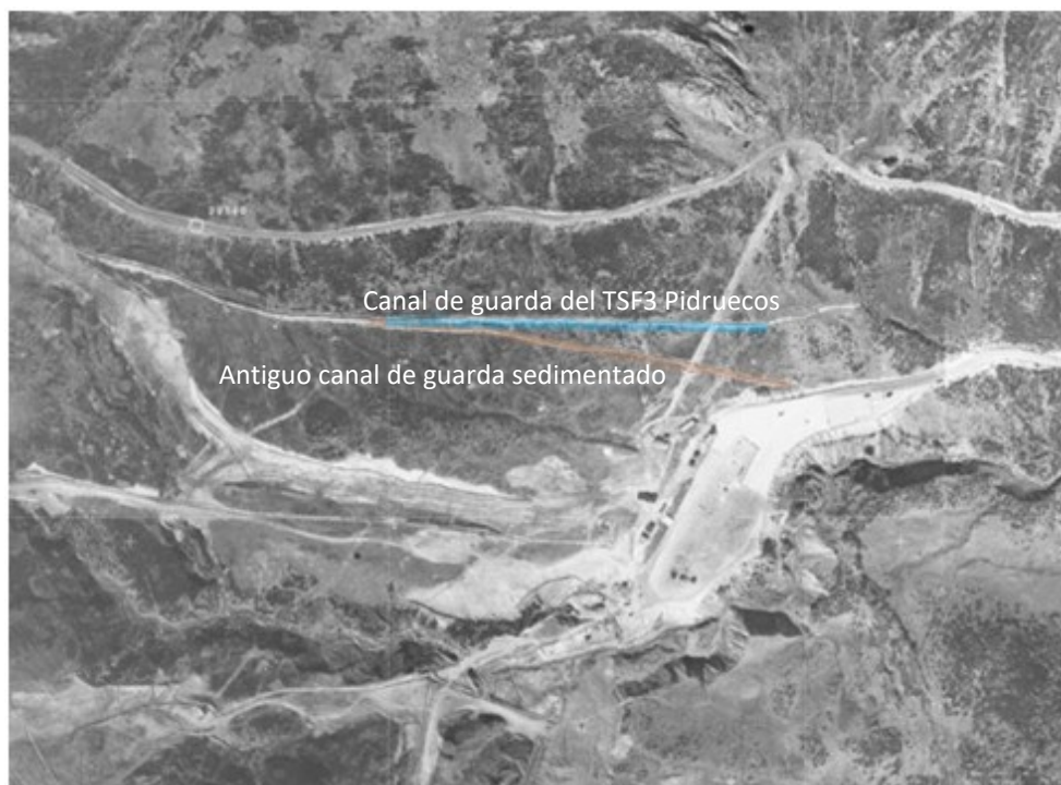
Ortofoto de los canales de guarda (1988). En azul, canal de guarda del TSF3 Pidruecos; en rojo, canal sedimentado.
