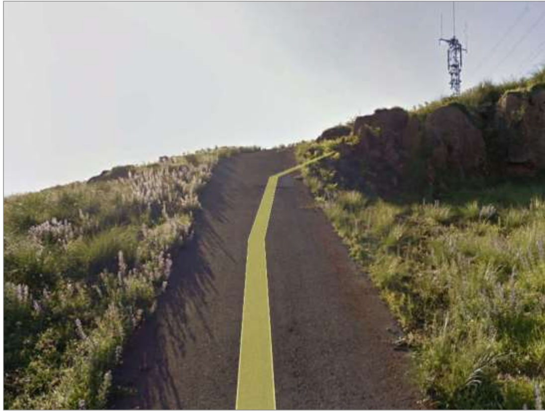
Fotografía 25. Trazado de nueva infraestructura de fibra óptica y electricidad BT por centro de calzada.
