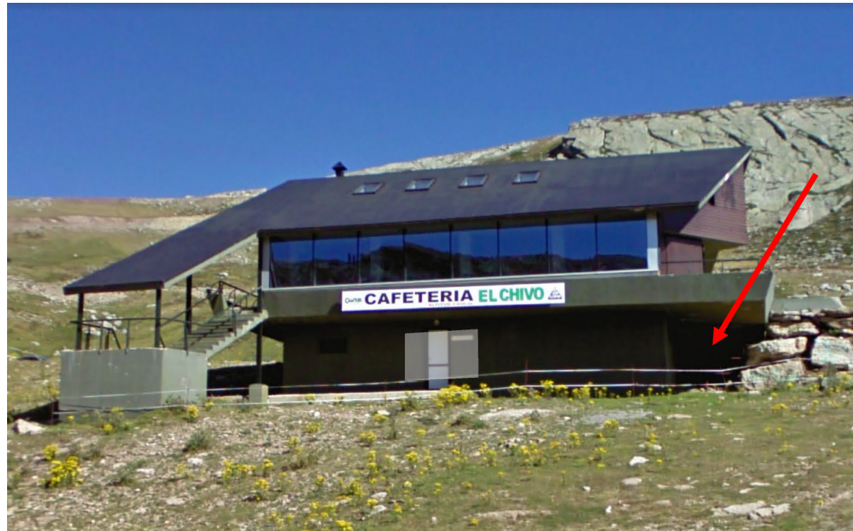
FOTO 5: En esta otra fotografía podemos apreciar, la cafetería "El Chivo". Donde aparece la flecha será la zona destinada a la colocación de los equipos de desinfección con ozono y para la mineralización. Será necesario acondicionar el suelo con la ejecución de una solera de hormigón armado y colocar una puerta en el hueco para restringir el paso.
