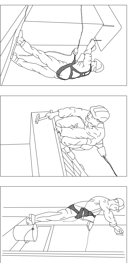
ANCLAJES CINTURON DE SEGURIDAD (Seguro de anclaje móvil)
